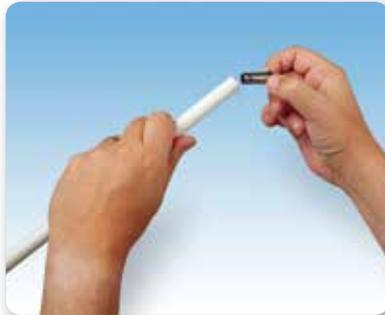
**2.** Inserta el casquillo SmartSleeve™ en el extremo de la tubería
