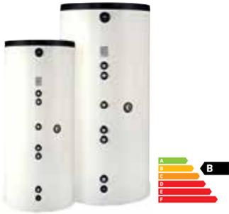
Acumulador doble fabricado en acero. La parte inferior se utiliza como depósito de inercia de calefacción y el depósito superior, fabricado en acero esmaltado, se utiliza para la producción de ACS. Los modelos ASC 800/200 E y 1000/250 E están ideados para instalaciones de energía solar térmica con apoyo a calefacción y ACS.
