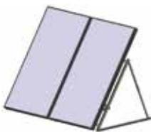
Soportes premontados para facilitar su instalación. Permiten variar la inclinación desde 30° a 55°. Para filas de más de dos colectores se deberán montar suplementos a partir del tercer colector. Por ejemplo, en una fila de 5 colectores se deberá montar un soporte para dos colectores y tres suplementos.
